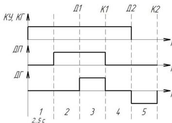
Рисунок 1 - Циклограмма работы автомата для сварки прямолинейного шва в углекислом газе
