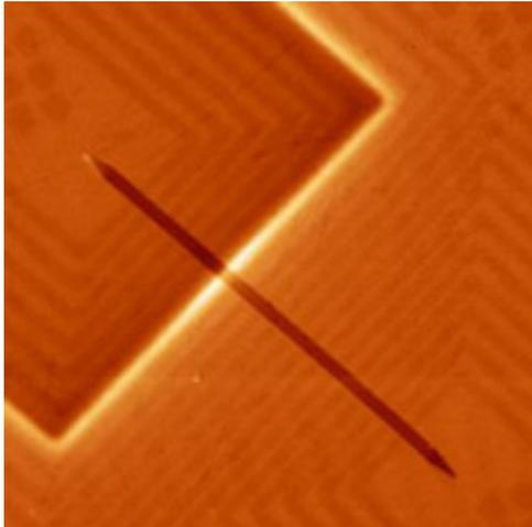
Пока устройство нельзя назвать полноценной памятью: перед нами единственный железно-никелевый нанопровод (тёмно-коричневый на снимке), служащий для проверки основных принципов (фото IBM).
